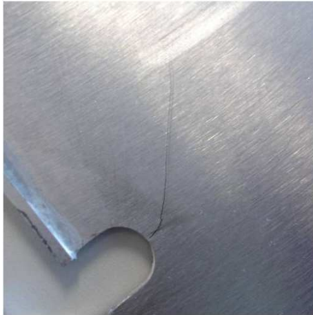
offener Riss - unlackiert
